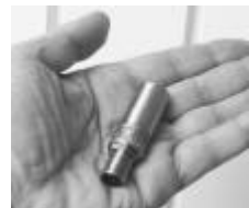
Abb.3: Durch den Einsatz modernster Microelektronik sind alle Funktionen in den Sensor integriert und keine weiteren externen Verstärker oder Schaltgeräte erforderlich
