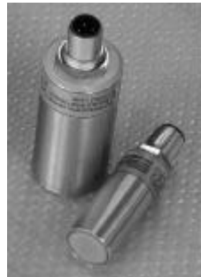
Abb.2: Einseitige blechberührende Doppelblech-Sensoren Für Stahl- Bleche bis max. 0,5 mm Dicke: Type S 0.5P4S Durchmesser: 18mm, Länge: 45 mm = EUR 256,-- Für Stahl- Bleche bis max. 1.0 mm Dicke: Type S 1.0P3S Durchmesser: 28 mm, Länge: 55 mm = EUR 358,-- Für Alu- Bleche bis max. 0,5 mm Dicke: Type SA 0.5P3S Durchmesser: 28 mm, Länge: 55 mm = EUR 373,--
