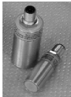
Abb.2: Einseitige blechberührende Doppelblech-Sensoren Für Stahl- Bleche bis max. 0,5 mm Dicke: Type S 0.5P4S Durchmesser: 18mm, Länge: 45 mm Für Stahl- Bleche bis max. 1.0 mm Dicke: Type S 1.0P3S Durchmesser: 28 mm, Länge: 55 mm Für Alu- Bleche bis max. 0,5 mm Dicke: Type SA 0.5P3S Durchmesser: 28 mm, Länge: 55 mm
