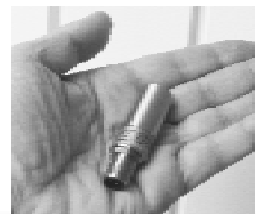
Abb.3: Durch den Einsatz modernster Mikroelektronik sind alle Funktionen in den Sensor integriert und keine weiteren externen Verstärker oder Schaltgeräte erforderlich.
